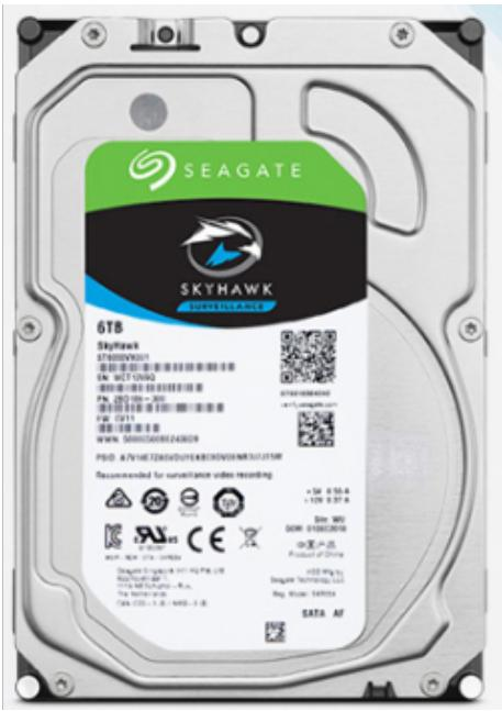
硬盘是一种采用磁介质的数据存储设备，数据存储在密封于洁净的硬盘驱动器内腔的若干个磁盘片上。这些盘片一般是在以的片基表面涂上磁性介质所形成，在磁盘片的每一面上，以转动轴为轴心、以一定的磁密度为间隔的若干个同心圆就被划分成磁道(track)[]每个磁道又被划分为若干个扇区(sector)[]数据就按扇区存放在硬盘上。在每一面上都相应地有一个读写磁头(head)[]所以不同磁头的所有相同位置的磁道就构成了所谓的柱面(cylinder)[]传统的硬盘读写都是以柱面、磁头、扇区为寻址方式的(CHS寻址)。硬盘在上电后保持高速旋转，位于磁头臂上的磁头悬浮在磁盘表面，可以通过步进电机在不同柱面之间移动，对不同的柱面进行读写。所以上电期间如果硬盘受到剧烈振荡，磁盘表面就容易被划伤，磁头也容易损坏，这都将给盘上存储的数据带来灾难性的后果。
